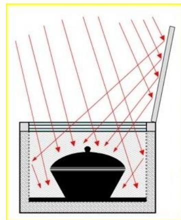
Um outro aspeto é a transmissão de calor que é importante reduzir nas paredes do forno solar de modo a conservar a energia dentro do forno, e por isso e que utilizamos a esferovite como isolante no nosso protótipo. Por outro lado temos que aumentar a transmissão de calor entre a base do forno e a panela ou outro instrumento de cozinha.
