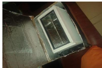
O passo seguinte foi experimentá-lo num dia de sol pela uma da tarde, experimentamos cozer um ovo e passado trinta minutos, tinha-mos um ovo totalmente cozido, e o vidro a uma temperatura considerável:
